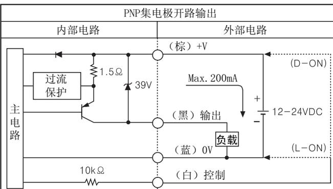
※ 可通过控制线选择Light ON/Dark ON模式。 [ Light ON:控制线接0V
