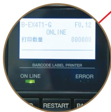
独特的LCD图形“帮助”显示屏可改善设置操作，降低使用培训要求。使得操作极为简便，在工业打印机中独树一帜。
